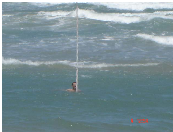
Figura 6: Medição da altura significativa de ondas com auxílio de uma régua de 5m.
