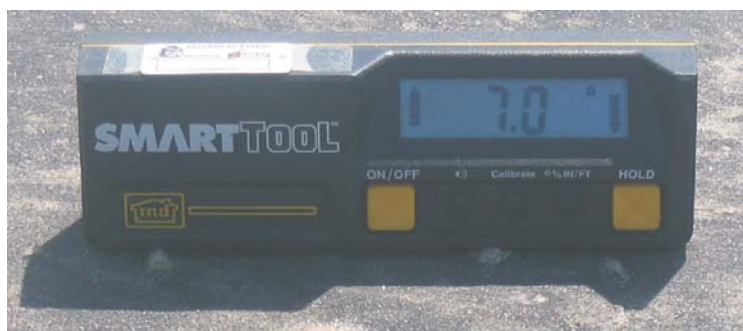
Figura 4: Clinometro calibrado em laboratório.
