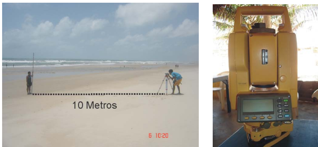
Figura 5: Levantamento topográfico com auxílio de estação total ou nível topográfico.
