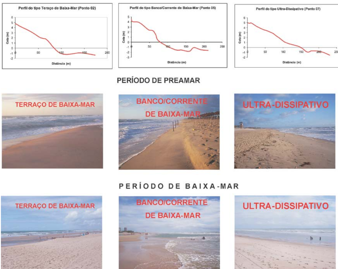
Figura 59: Perfil representativo e caracterização dos diferentes estágios morfodinâmicos encontrados nos ciclos de preamar e baixa-mar.
