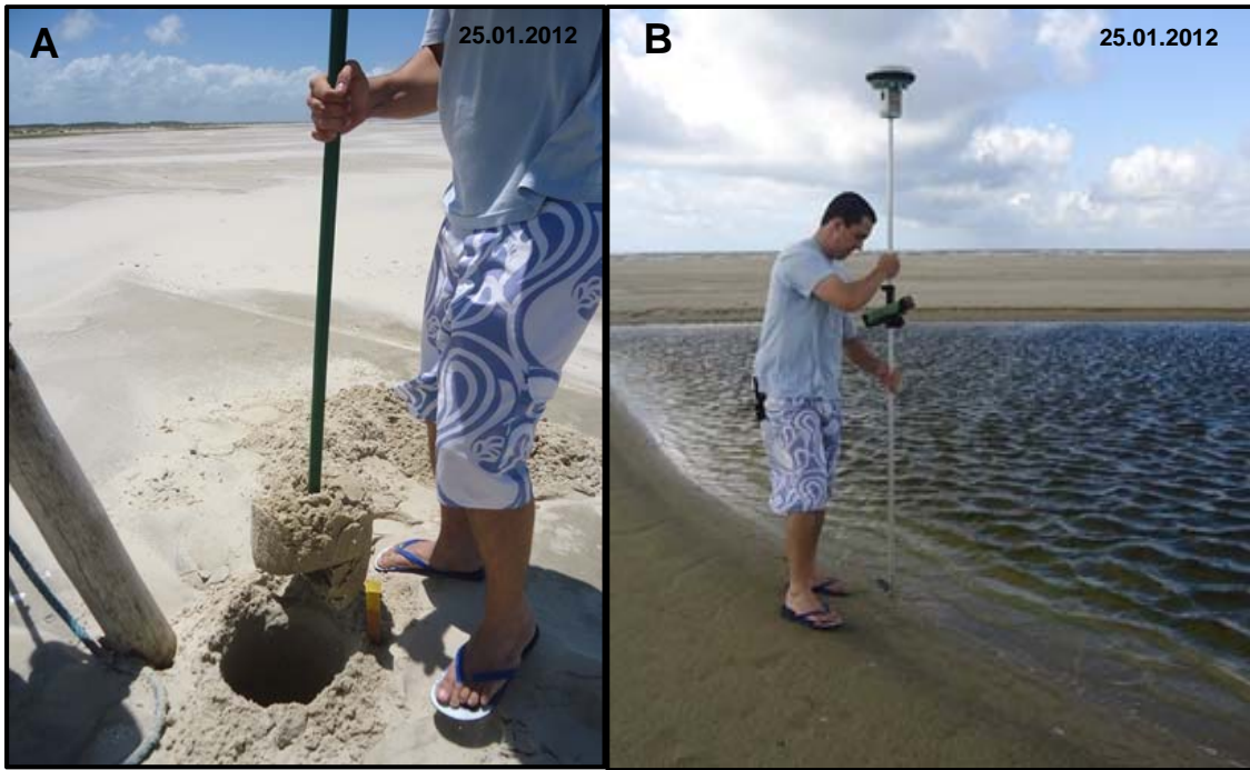
Figura 4.3. – A: Execução de furos de sondagem com trado manual para medição de nível do lençol freático. B: Levantamento topográfico da posição das bordas do sangradouro, com o auxílio de GPS geodésico.
