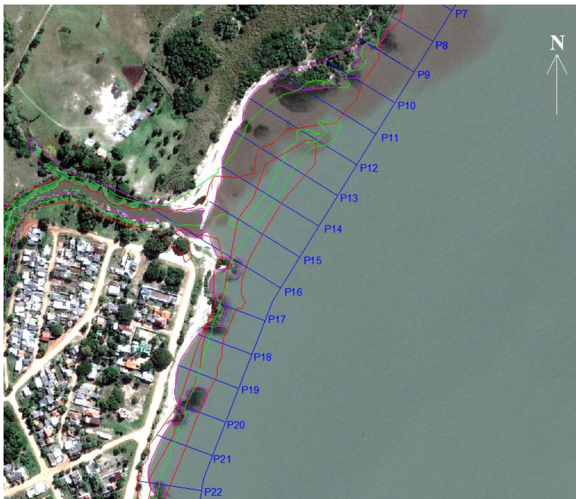
Figura 3.3: Linha auxiliar com perfis perpendiculares à linha de costa (em azul). Linha de costa do ano de 1953 (em vermelho). Linha de costa do ano de 1977 (em verde). Linha de costa do ano de 2010 (em rosa).
