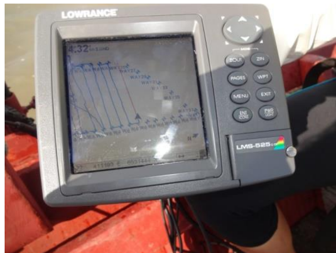
Figura 3.11: Tela da ecossonda da ecossonda com as linhas de navegação.
