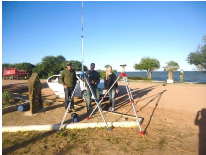
Figura 3.1: Instalação do sensor GNSS sobre o RN.
