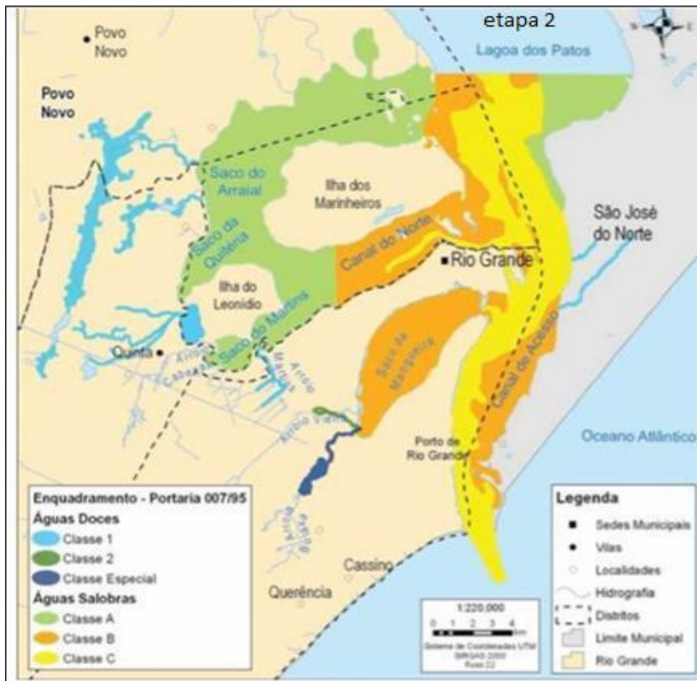
Figura 2 - Classificação e proposta de enquadramento das águas da parte sul do estuário da Lagoa dos Patos: Etapa 1. Obs.: Etapa 2 não foi realizada no norte do estuário (FEPAM, 1995.Extraído de ENGEPLUS, 2013).
