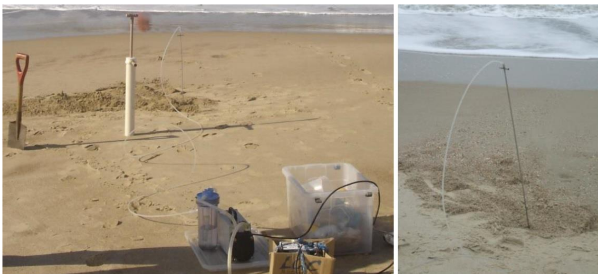
Figura 12: Coleta de água subterrânea na zona de praia com auxílio de Push-point . Fonte: Attisano (2012).
