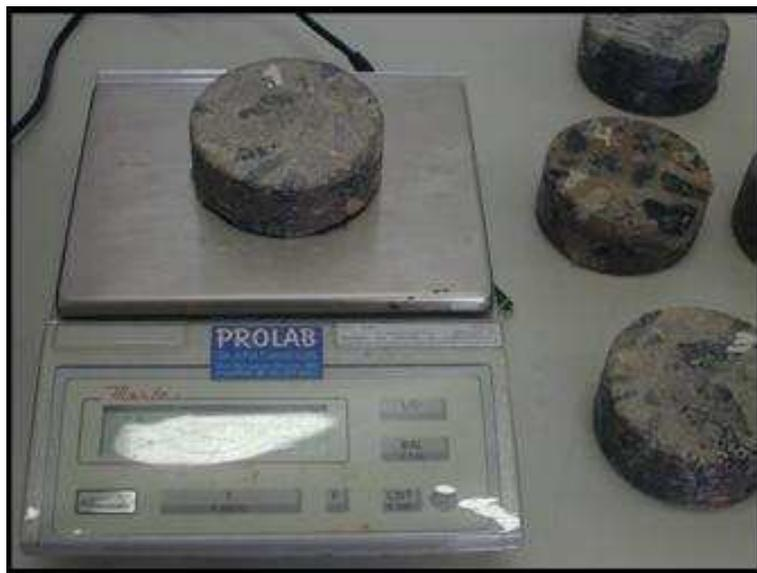
Figura 2: Pesagem dos corpos de prova
