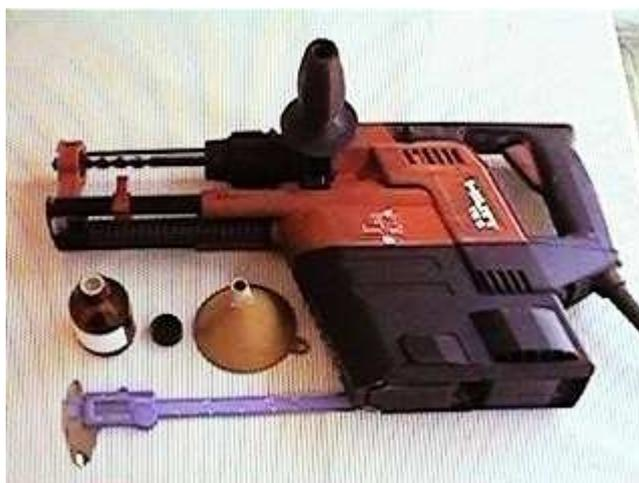
**Figura 2** – Furadeira e equipamentos utilizados na coleta das amostras.
