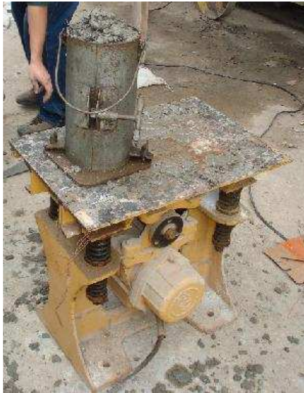
Figura 5 – Mesa vibratória utilizada na moldagem dos corpos de prova
