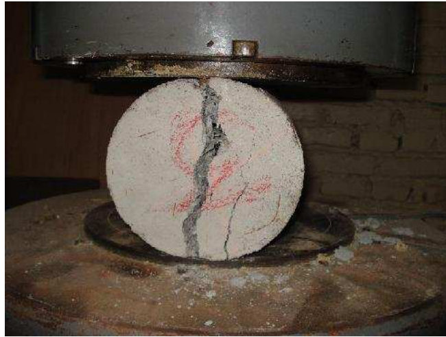
Figura 8 – Corpo de prova submetido ao ensaio de tração indireta
