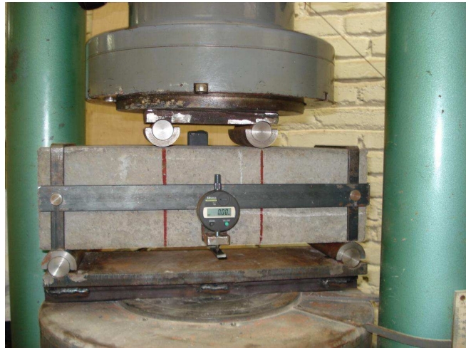
Figura 9 – Corpo de prova submetido ao ensaio de tração na flexão
