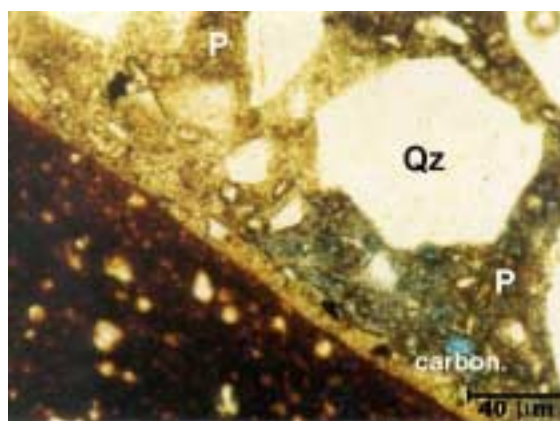
Fotomicrografia 1 - Am. 148. Polarizadores cruzados. Presença de carbonatação no contato do agregado cerâmico com a pasta.
