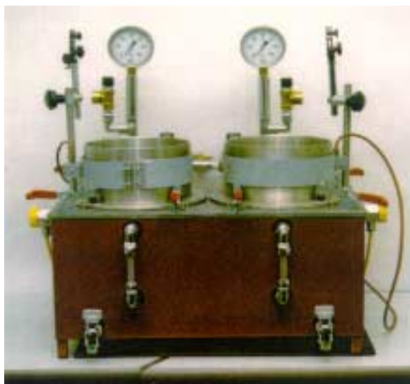
Foto 1. Máquina tratamiento vapor para escorias.
