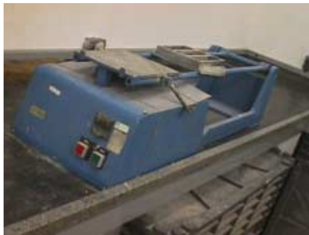
Figura 1 – Vibrador mecânico para moldagem dos cps prismáticos.
