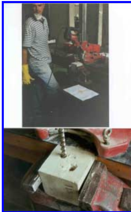
Figura 1 Amostras coletadas, determinação do teor de cloretos nas camadas de 0-1, 1-2 e 2-3 cm
