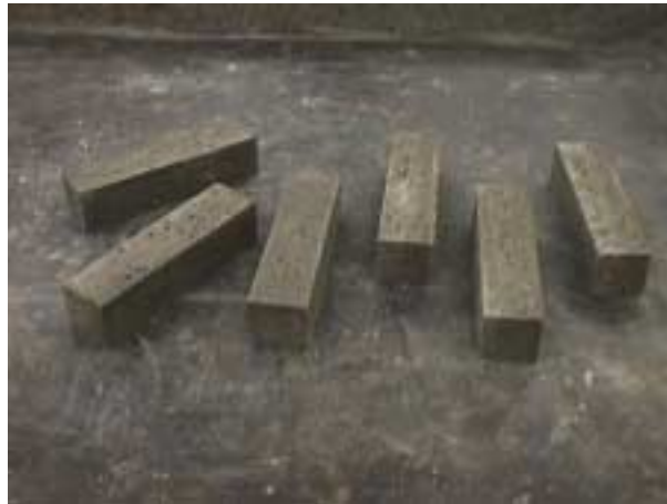
Figura 2 – Cps prismáticos desmoldados..
