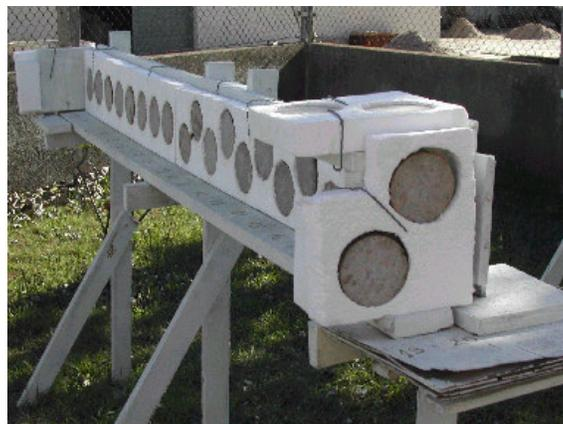
Figura 4 – Testemunhos expostos no suporte projetado
