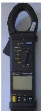
Figura 8 –Amperímetro utilizado para medição corrente
