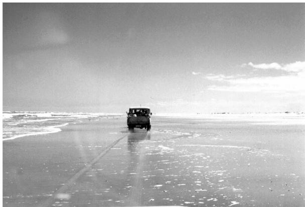
Figura 2 - Levantamento da linha de praia com sistema de posicionamento global – GPS, fixado em um veículo que se desloca ao longo da linha de água associada ao espraiamento da onda.
