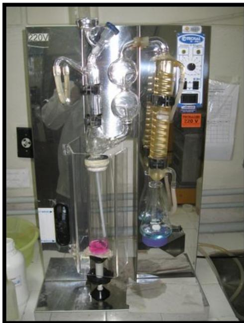
**Figura 23.** Destilador de nitrogênio, utilizado para quantificação de BVT.
