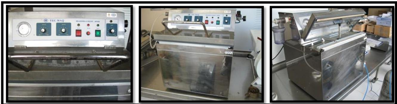
**Figura 13.** Termo selador a vácuo, injetora de gases (TECMAQ AP 450).
