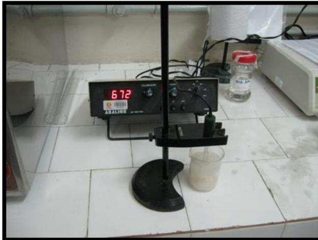
**Figura 24.** Potenciômetro utilizado para aferição do pH.
