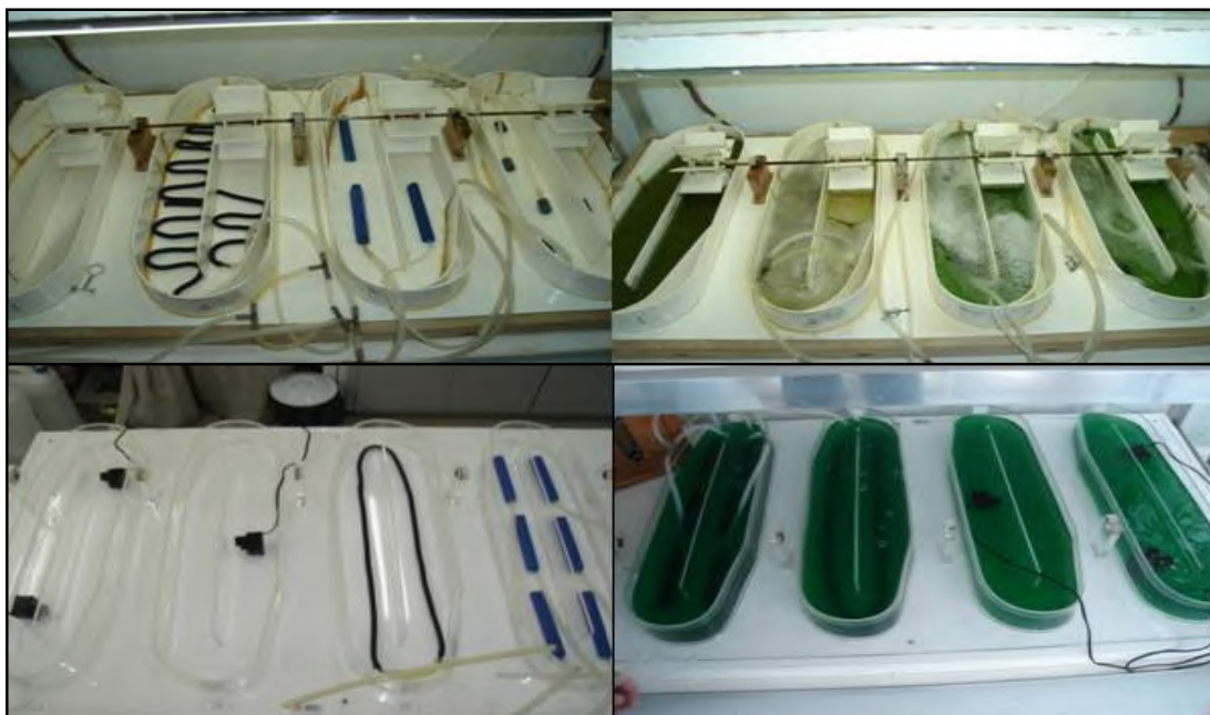
Figura A2 Fotobiorreatores abertos tipo raceway utilizados no cultivo das microalgas Cyanobium e Chlorella .
