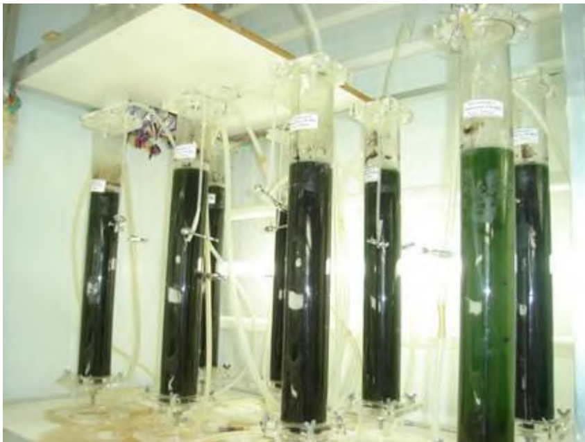
Figura A3 Cultivos com a microalga Cyanobium realizados em fotobiorreatores tubulares de 2 L.
