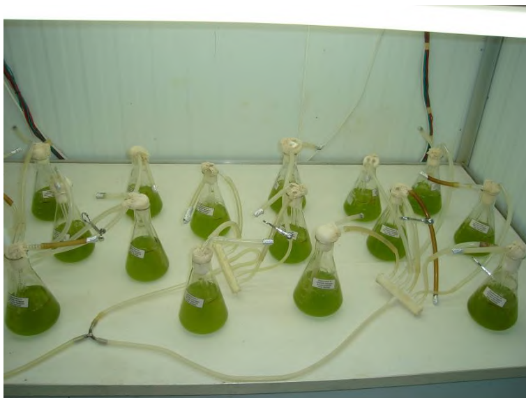
Figura A1 Cultivos realizados em fotobiorreatores tipo erlenmeyer de 0,5 L.
