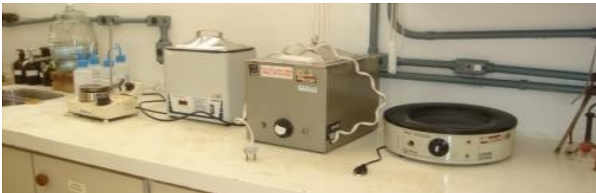
a. Bancadas de madeira revestidas com formica, com bicos de gás e equipamentos geradores de calor
