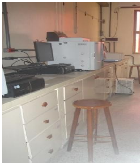
b. Bancadas projetadas sem recuo para pernas.
