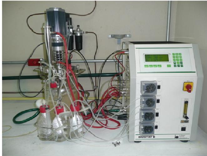
**Figura 2.** Biorreator Biostat B (B. Braun Biotech International, Alemanha) com capacidade de 5 L utilizado para o cultivo da levedura *Yarrowia lipolytica* NRRL YB-423.
