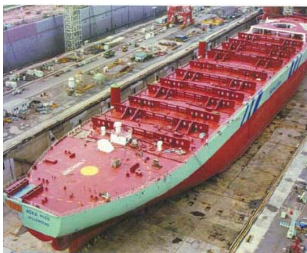
Figura 3.8 – Suportação com viga transversal (Plataforma Aoka Mizu, Reino Unido)
