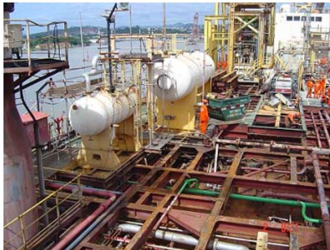
Figura 3.1 – Estrado metálico ou pancake (P-34)
