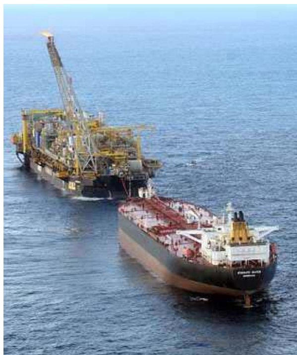
Figura 2.12 – Operação de alívio da FPSO P-50 para navio petroleiro
