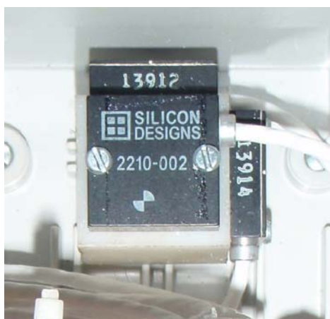
Figura 5.7 – Instalação dos acelerômetros
