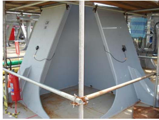
Figura 5.2 – Foto de um stool com extensômetros instalados
