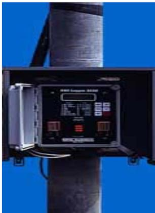
*Figura 2.12 Registrador de dados (data logger ou computador de vento)*
