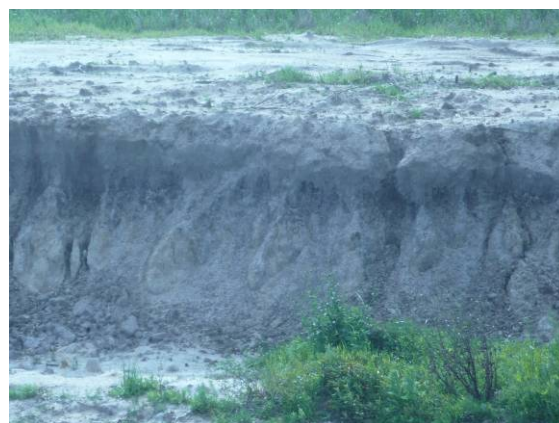
Figura 7.78 – Perfil da unidade Plpl2, onde percebem-se processos erosivos característicos dos solos da unidade, próximo ao ponto v18p1.
