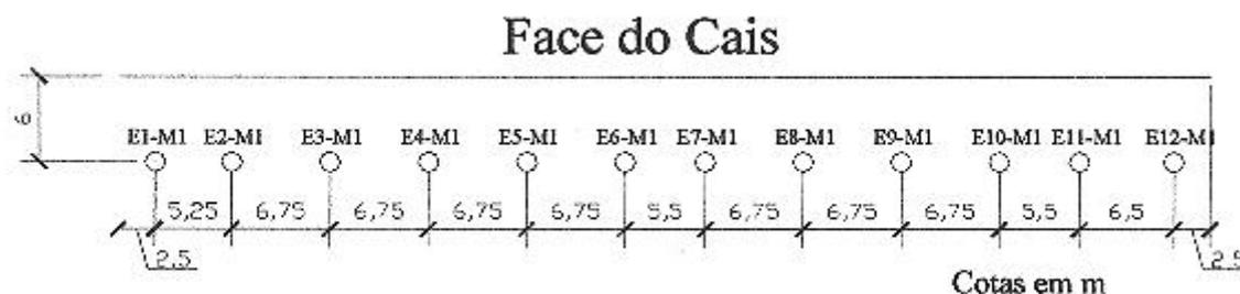
Figura 5.5 – Disposição construtiva das estacas em um módulo do cais. – Lobo (2003).
