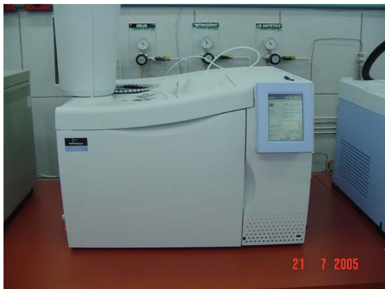
Figura 7 – Cromatógrafo de fase gasosa Perkin Elmer Clarus 500 equipado com detector de captura de elétrons (GC-DCE).
