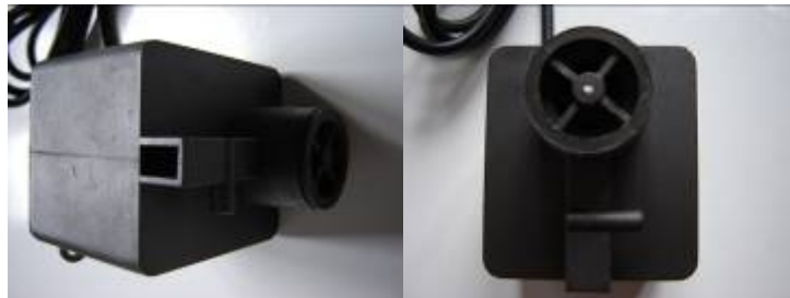
Figura 4.10 – Detalhe da bomba de circulação d'água
