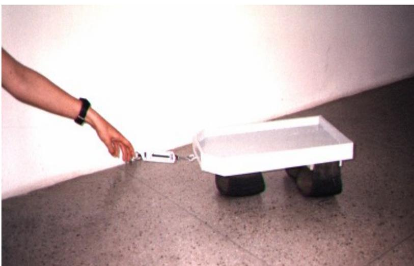
*Fig. 2 - Arrastando o aparelho para medir o coeficiente de atrito.*
