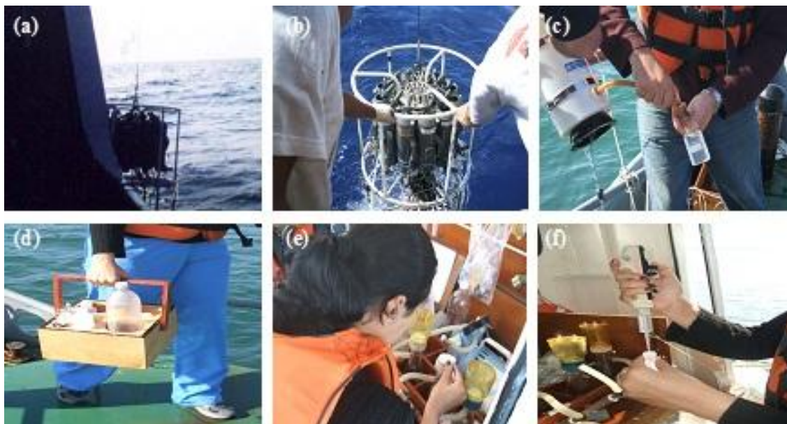
Figura 2. Procedimento de coleta. (a) e (b): lançamento e retorno da roseta; (c): coleta de amostra de água para análise de oxigênio dissolvido; (d): transporte das amostras; (e): filtração das amostras e (f): subdivisão das amostras (Fonte: Attisano, 2007).
