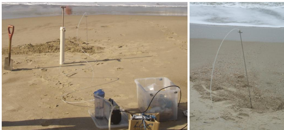
Figura 4. Coleta de água subterrânea na zona de praia com auxílio do Push-Point .
