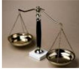
Figura 1 – Balança de dois pratos
