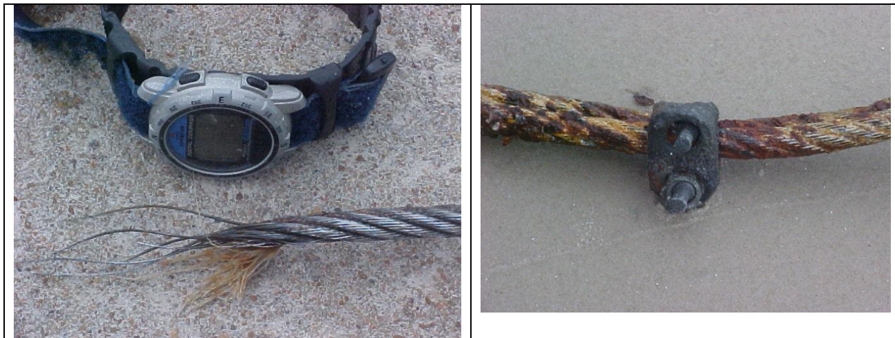
Fig A-8 - Detalhe do cabo de aço rompido e das más condições da manilha no terceiro desgarre.
