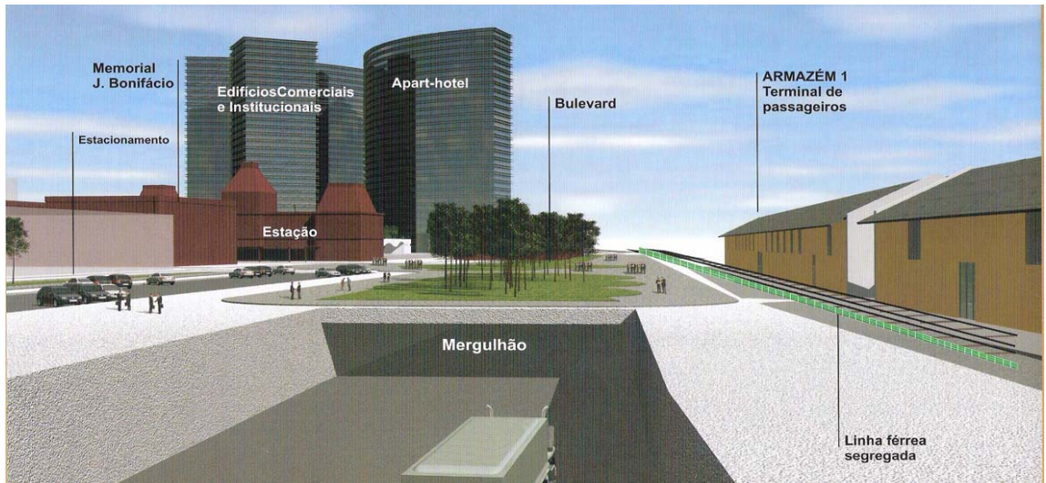
Figura 5 - Detalhe do projeto com o "mergulhão" em frente aos armazéns, possibilitando a construção do boulevard.
