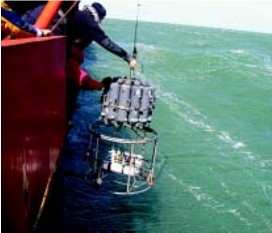
Figura 7. Operação de CTD, equipamento utilizado para colher amostras de água e medir temperatura e salinidade
