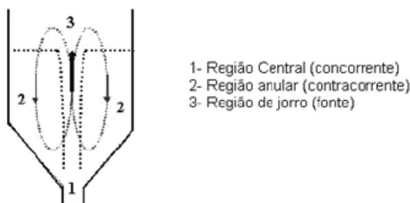
Figura 7: Diagrama esquemático de um leito de jorro cone-cilíndrico (CSB).
