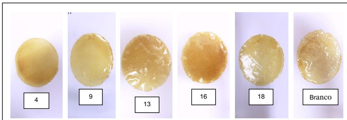
Onde: 4 (4,0 g de PR, 1,35 g de G, 0,4 g de MMT e 1,0 mL de OEC); 9 (3,0 g de PR, 0,75 g de G, 0,4 g de MMT e 1,0 mL de OEO); 13 (3,0 g de PR, 0,75 g de G, 0,6 g de MMT, 1,0 mL de OEO e 1,0 mL de OEC); 16 (4,0 g de PR, 1,35 g de G, 0,6 g de MMT, 1,0 mL de OEO e 1,0 mL de OEC); 18 (3,5 g de PR, 1,05 g de G, 0,5 g de MMT, 0,5 mL de OEO e 0,5 mL de OEC); Branco (3,5 g de PR e 1,05 g de G).
