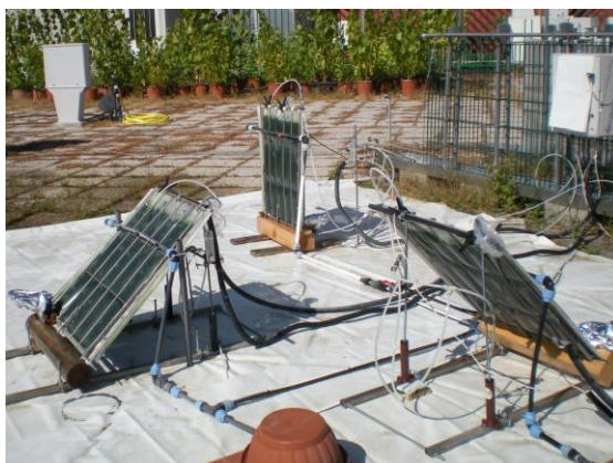
FIGURA 3 Fotobiorreatores Green Wall Panel vertical, inclinado para o sul e inclinado para o norte
