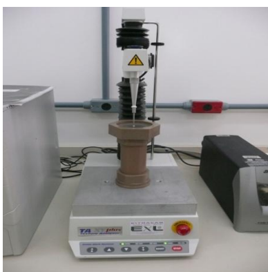
Figura 4.3 Dispositivo para análise de perfuração desenhado e fabricado pelo autor desta pesquisa
