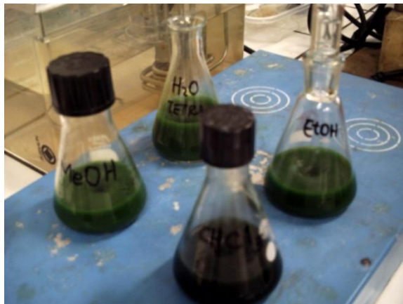
Figura 2 Extração seqüencial de biossurfactantes das microalgas
