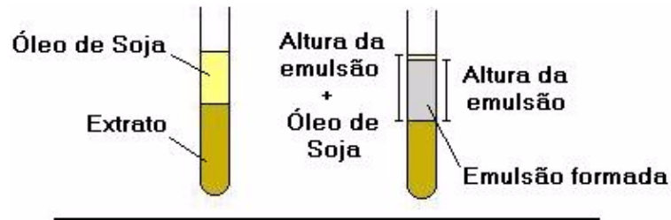
Figura 2 Representação esquemática do ensaio da atividade emulsificante
