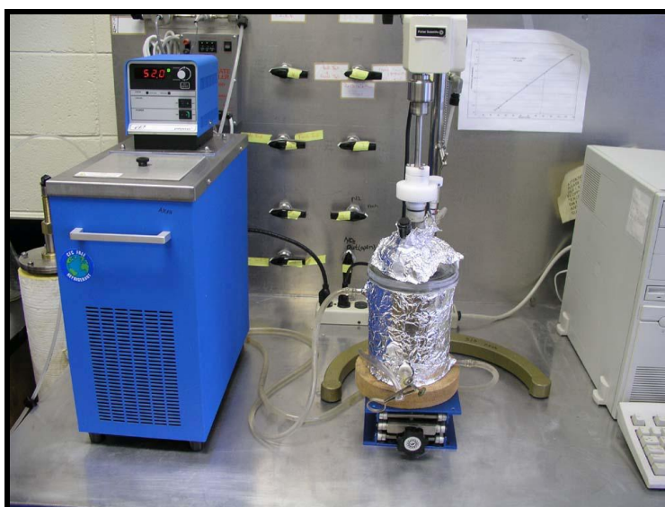
Figura 11. Reator de vidro encamisado com agitação mecânica Fonte: Filleti-Junior (2005).
