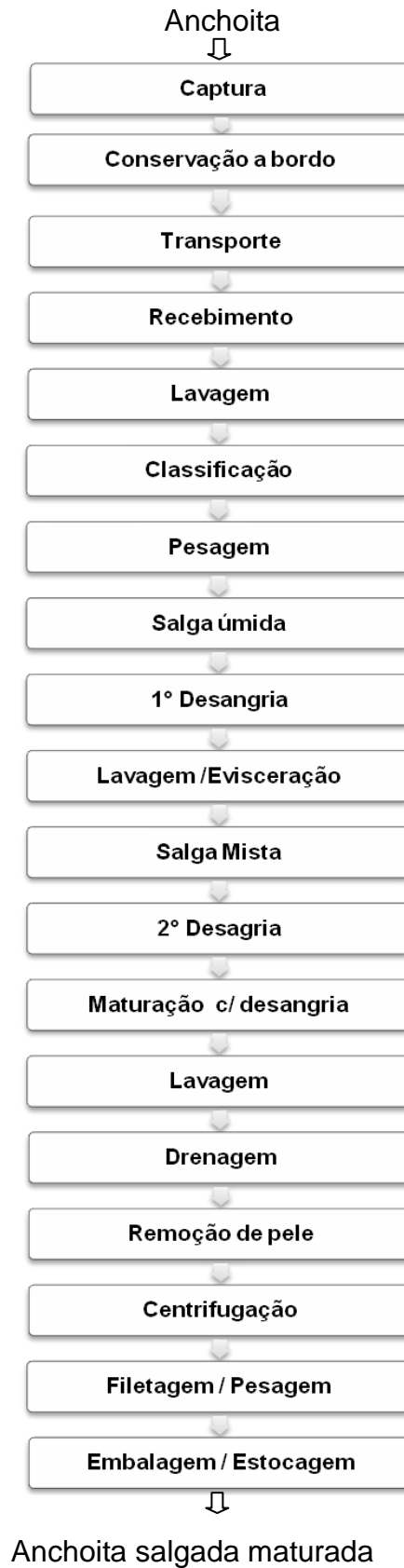
Figura 4 Processamento da anchoita salgada maturada e embalada sob atmosfera modificada
