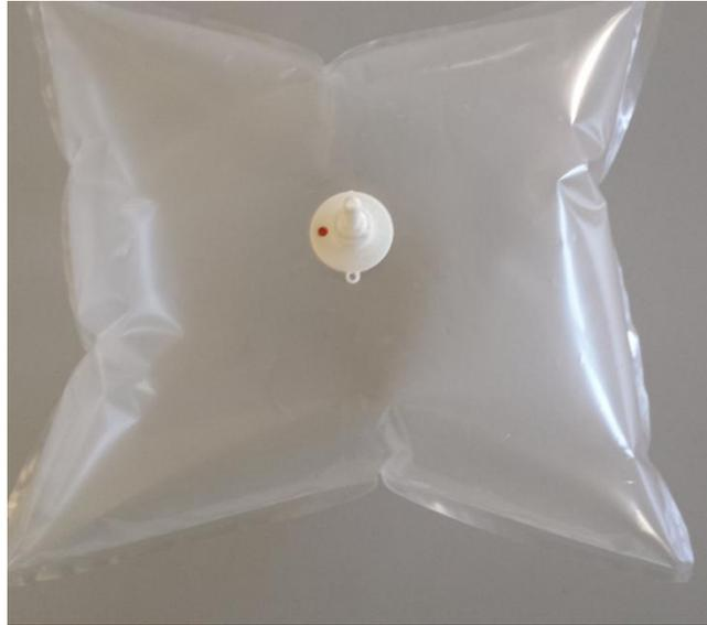
**Figura 10** Reatores anaeróbios de 2 L utilizados nos ensaios
