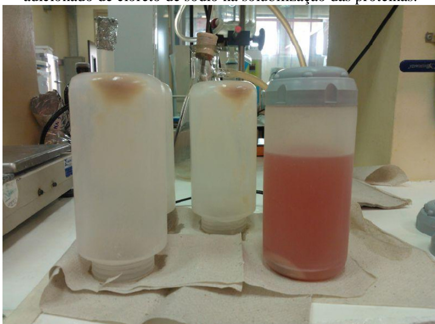
Figura 13 – Tubos contendo baixa proteína precipitada do isolado proteico de frango adicionado de cloreto de sódio na solubilização das proteínas.
