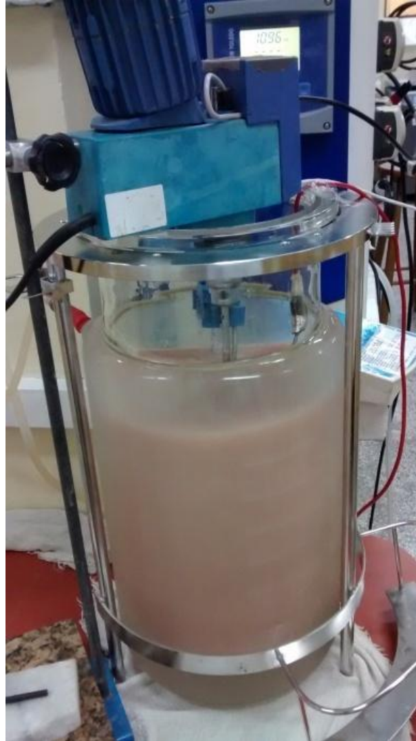
Figura 16 – Equipamento utilizado para aumento de escala do processo de isolado proteico de frango.
