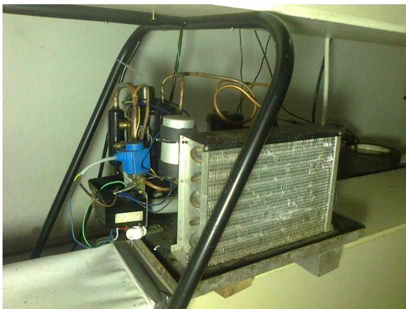
Figura A.9: Foto do painel de controle do secador de bandeja com bomba de calor.
