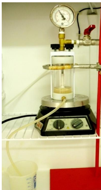
Figura 1 – Célula de ultrafiltração utilizada na concentração e purificação da enzima \beta -galactosidase.
