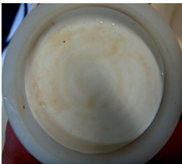
Figura 9 – Formação do fouling na membrana: fenômeno que ocasiona redução do fluxo de permeado.
