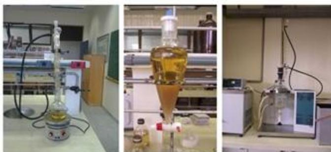
**Figura 38** – Equipamentos utilizados nas reações em escala de bancada: aparato de reação em escala 200 mL (esq.), funil de separação para escala 200 mL (centro) e sistema reacional para escala de 2 L (dir.).
