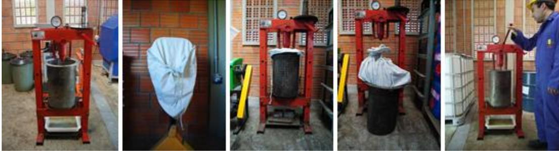
**Figura 35** – Prensa hidráulica e acessórios utilizados na prensagem do lodo de extração.
