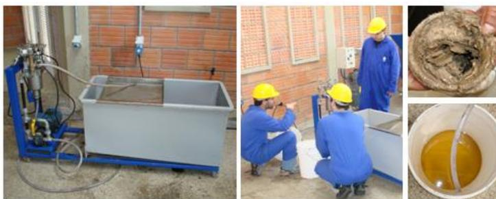
**Figura 36** – Filtro Hayward (esq.) utilizado na obtenção da micela, filtração na Usina BIOSUL (centro), farinhaeta retida no bag (sup. dir.) e micela filtrada (inf. dir.).
