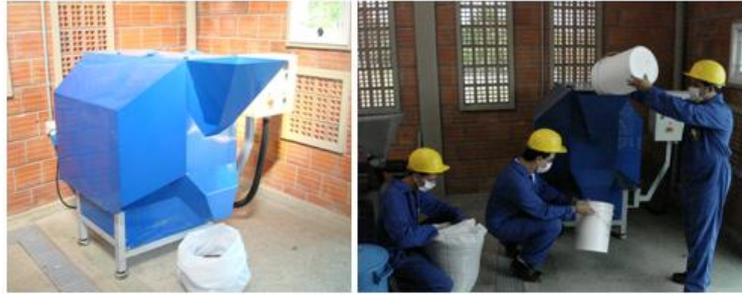
**Figura 20** – Secador rotativo Scott Tech SMR 610 utilizado na secagem das sementes.
