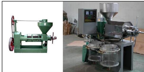
**Figura 6** – Exemplos de prensas mecânicas contínuas disponíveis comercialmente.
