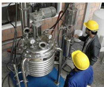
**Figura 37** – Recuperação de solvente em escala piloto utilizando o sistema de destilação do reator.
