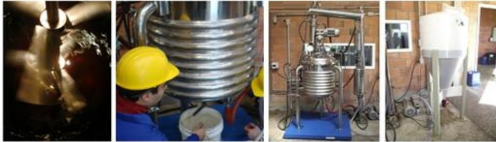
**Figura 41** – Experimentos de produção de biodiesel por catálise básica em escala piloto de 200L.
