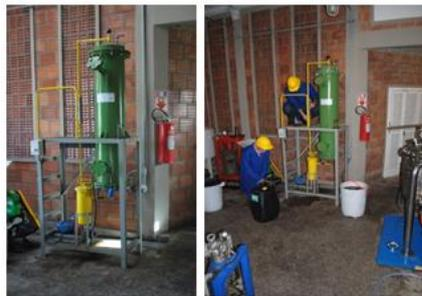
**Figura 42** – Permeação por leito preenchido a 1/3 (vol.) por resina de troca iônica Amberlite® BD10DRY®.
