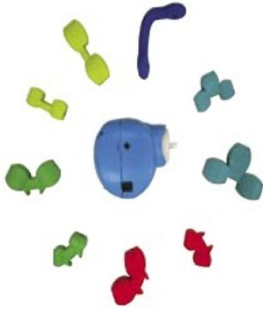
Figure 1. Conjunto de primitivas ativas e passivas que formam o Topobo
