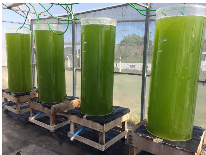
Figura 1: Sistema de cultivo da microalga *N. oceanica* por fotobiorreatores em estufa do Laboratório de Produção de Microalgas na Estação Marinha de Aquacultura - FURG.
