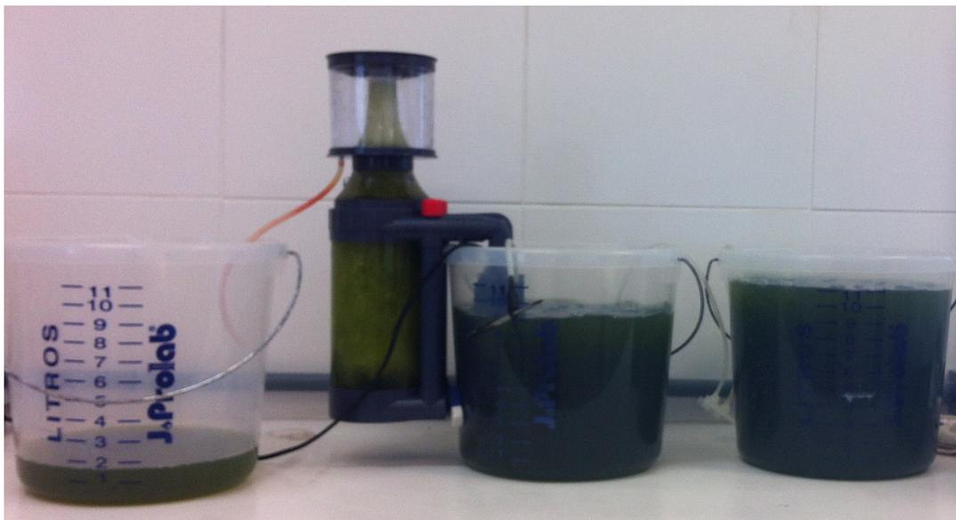
Figura 1: Sistema de remoção de MOD com “skimmer” DG-2516. Da esquerda para a direita os tratamentos: Descarte, “Skimmer” e Controle Positivo.
