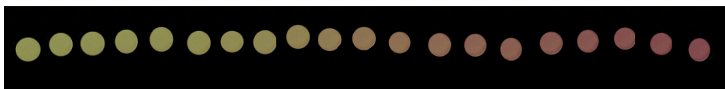
Figura 13: Um único adesivo termocrômico exposto a uma temperatura inicial de 23,8 °C até a temperatura final de 98,5 °C.
