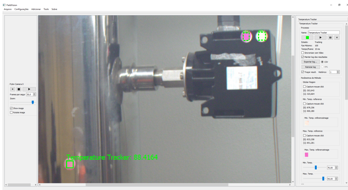
Figura 18: IHM do FiedVision com os Sensor Visual de Temperatura já ajustado e realizando a medição da temperatura em um tanque de inox.
