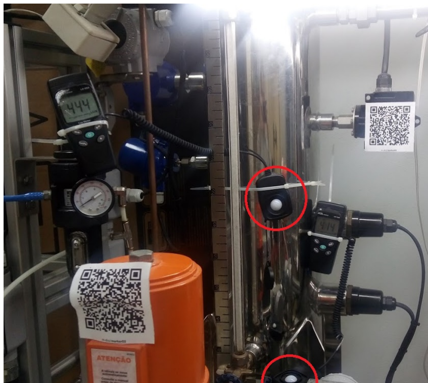
Figura 25: Luxímetros instalados na planta piloto, no plano horizontal de trabalho a 1m do piso e plano vertical a 50% do visor de nível (Área Sensoreada).
