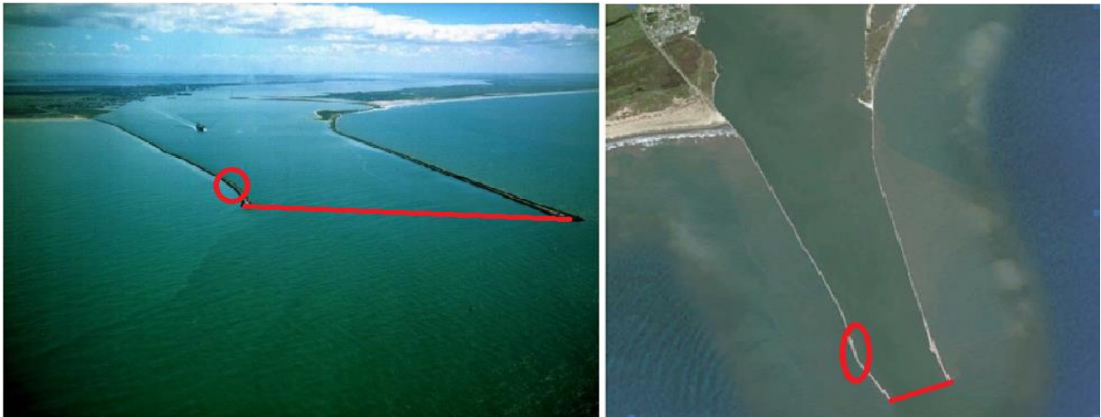
Figura 10: Configuração dos molhes da Barra antes do prolongamento e aprofundamento e após a obra. Fonte: site da prefeitura do Rio Grande e Google Earth.
