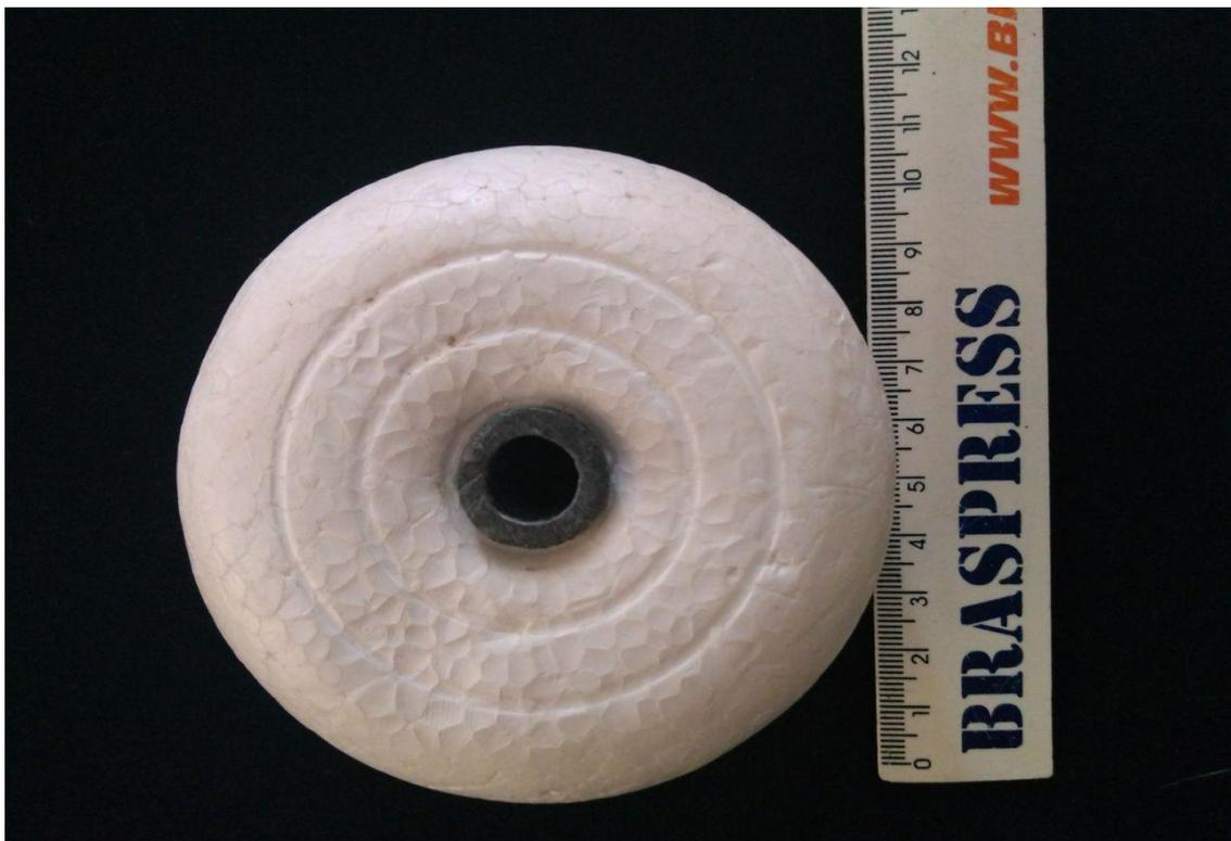
Figura 32: Derivador utilizado para medição da velocidade da corrente e posterior estimativa da vazão dos sangradouros. Foto: A autora.
