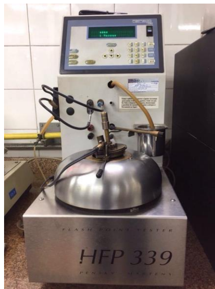
FIGURA 9 – Flash Point Analyzer Closed Cup Pensky-Martens® para determinação do Ponto de Fulgor e Ponto de Combustão
