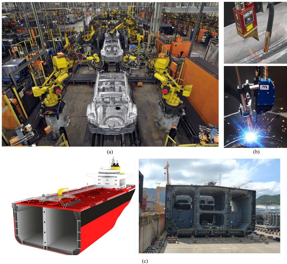
Figura 1: (a) Linha de produção de uma indústria automotiva com robôs e gabaritos mecânicos para soldagem, em (b) sistemas comerciais com uso de lasers para identificação de chanfros, e em (c), design e construção de navios de casco duplo - destaca-se as aberturas entre 500-700 mm 2 para acesso. Imagens adaptadas da internet.
