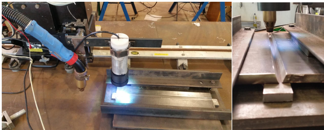
Figura 16: À esquerda: execução do método proposto - estimação do chanfro e centro da junta é feita em toda a extensão do chanfro. À direita: operador posiciona visualmente a ponta do arame no centro da junta em diferentes pontos do chanfro e tais posições são anotadas.
