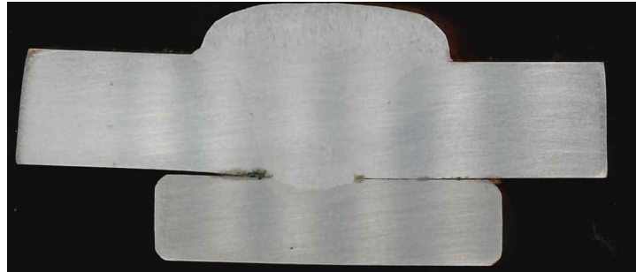
(a) Seção transversal próxima ao início da chapa soldada, após a estabilização do cordão.
