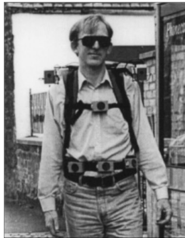
Figura 4.9: Sistema com visão estéreo e sensores de ultrassom.
