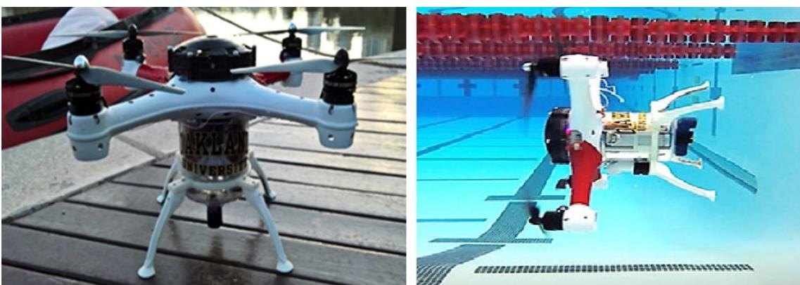
Figura 2.9: Loon Copter, HUAUV apresentado em Alzu'bi et al. 2017.
