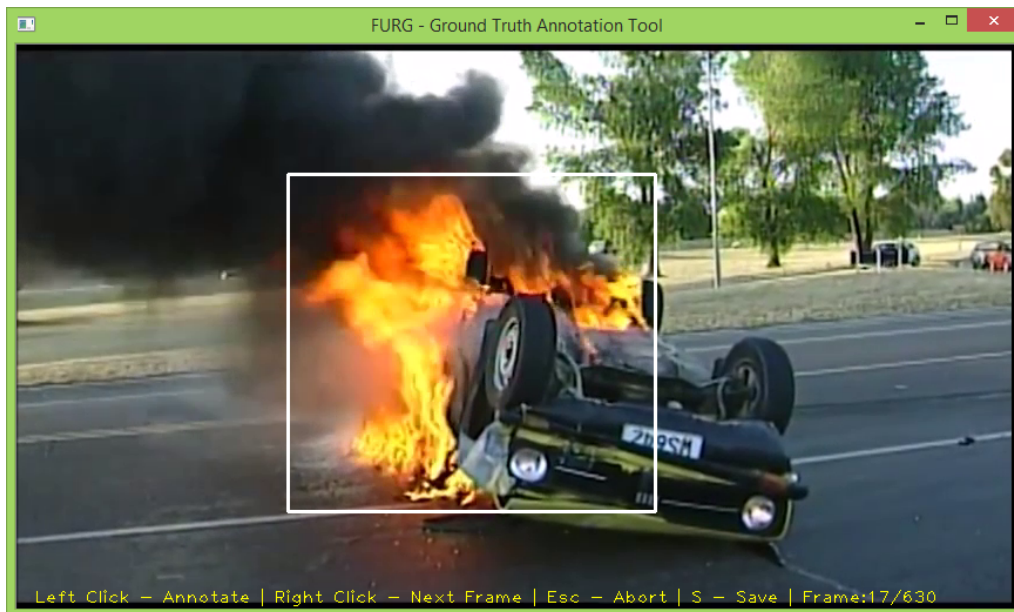
Figura 6: Anotações de ground truth no dataset . A ferramenta de anotações desenvolvidas permite delimitar as regiões de fogo utilizando retângulos e salvá-las em um arquivo XML para que possam ser utilizadas posteriormente.
